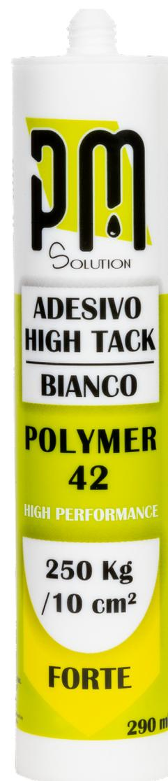
**CARATTERISTICHE:** Sigillante adesivo elastico monocomponente, a base di polimeri ibridi con terminazione silanica, ha un effetto ventosa per un attacco immediato. Può essere usato in immersione e su superfici umide. Dopo la completa reticolazione il prodotto è permanentemente elastico, ma mostra tuttavia una elevata forza meccanica. E' sovraverniciabile con pitture acriliche.
